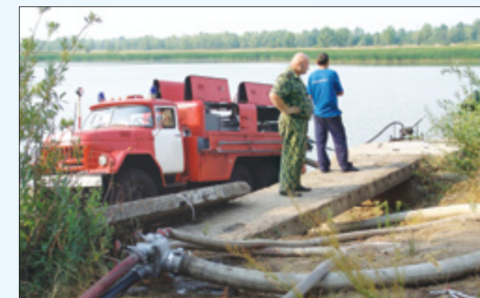
Передвижная насосная станция в действии
